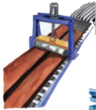
'n Ander masjien word gebruik om die stroke in blokke te sny.
