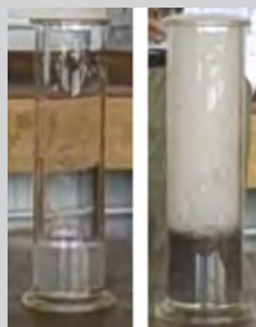
Figuur 7.3: \text{H}_2\text{O}_2 voor \text{MnO}_2 bygevoeg word (links) en na \text{MnO}_2 bygevoeg is (regs).
