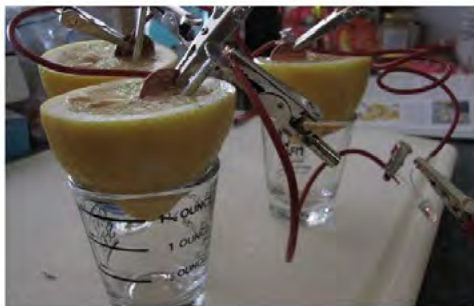
Figuur 13.2: 'n Stroom word verkry deur suurlemoene met koper- en sinkmetaal aan mekaar te verbind. Die reaksies wat hier plaasvind is elektrochemiese reaksies.
